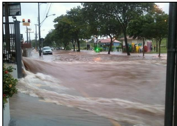
Figura 6 - Observe o volume de água que escoava para o fundo de vale que se encontra canalizado. O córrego não consegue "absorver" toda a água advinda das áreas de topo e vertentes.
