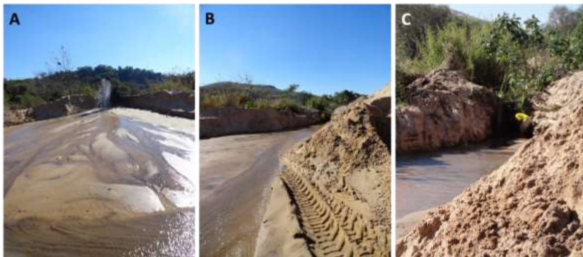
Figura 2 – Porto 1, Ribeirão Claro/PR. A: Chegada da draga e peneiramento da areia; B e C: canal para retorno da água ao rio Anhumas, Ribeirão Claro/PR
