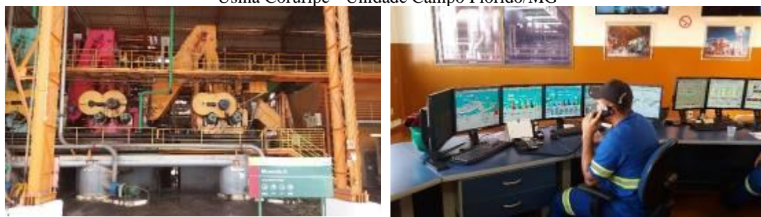
Figura 3 – Sistema de moagem automatizada (a esquerda) e Centro de Operações Integradas (COI) (a direita) da Usina Coruripe - Unidade Campo Florido/MG
