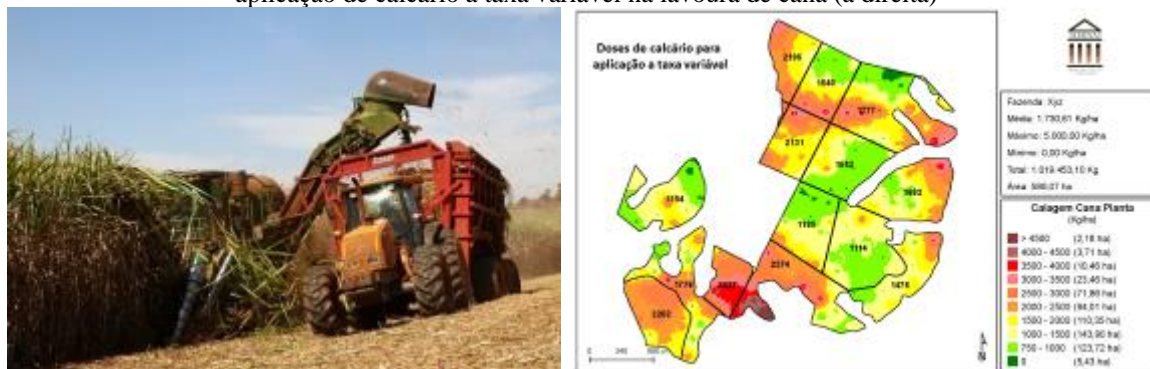
Figura 2 – Colheita mecanizada da cana-de-açúcar da Usina Vale do Tijuco – CMAA (a esquerda) e mapa de aplicação de calcário a taxa variável na lavoura de cana (a direita)
