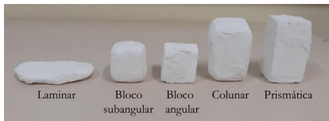
Figura 4 - Tipos de estrutura do solo confeccionadas com isopor e massa corrida na sua superfície externa para dar maior resistência e durabilidade.
