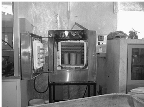
Figura 4 – Forno utilizado de maior capacidade e com controle de temperatura, utilizado para o aquecimento dos corpos de prova.
