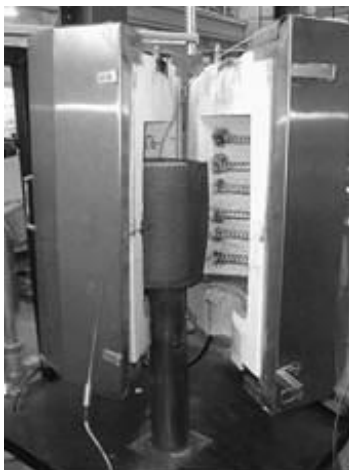
Figura 3 – Detalhe de corpo de prova monitorado pelos termopares.
