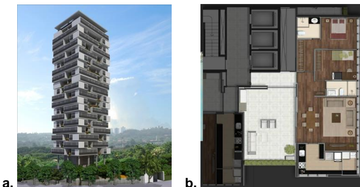
Figura 03 – a. Imagem do edifício 360°, Isay Weinfeld. Com três opções de tipologia o edifício 360° busca garantir a todos os espaços uma vista para a cidade; Figura 03 – b. Planta do edifício 360°, Isay Weinfeld. A tipologia de 130 m 2 mantém a recorrente disposição dos dormitórios e da cozinha nas extremidades da planta. Fonte: http://www.edificio360.com.br , 2012.
