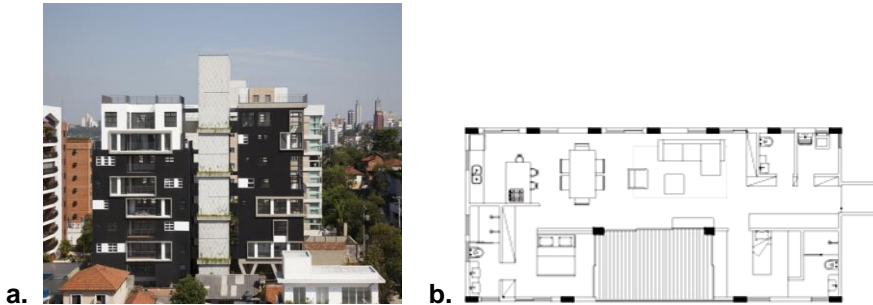
Figura 01 – a. Imagem do edifício Fidalga 727, Triptyque. A fragmentação do edifício Fidalga 727 em três partes tem como intuito integrar a área de convívio aos espaços de circulação vertical e horizontal; Figura 01 – b. Planta do edifício Fidalga 727, Triptyque. A tipologia loft com um ou dois dormitórios possui no centro o terraço, organizando a disposição dos ambientes.
