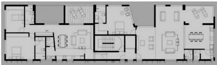
Figura 04 – Planta do edifício Aimerê, Andrade Morettin. As unidades no edifício Aimerê apresentam plantas livres possibilitando, como é o caso do segundo pavimento, que os espaços sejam integrados ou compartimentados. Fonte: http://www.archdaily.com.br/35386/edificio-na-rua-aimbere-andrade-morettin-arquitetos/ , 2012.
