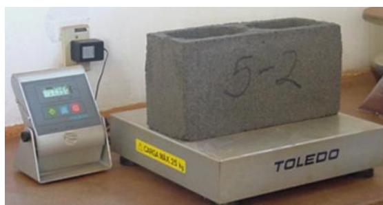
Figura 3 – Amostra de bloco de concreto sendo pesado na balança digital.
