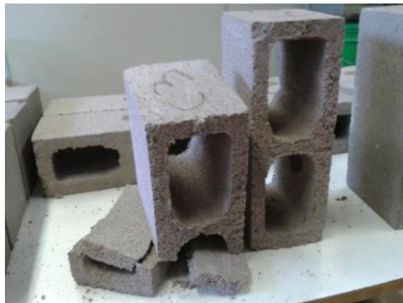
Figura 11 – Bloco de concreto da empresa C que se quebrou durante o teste do som.
