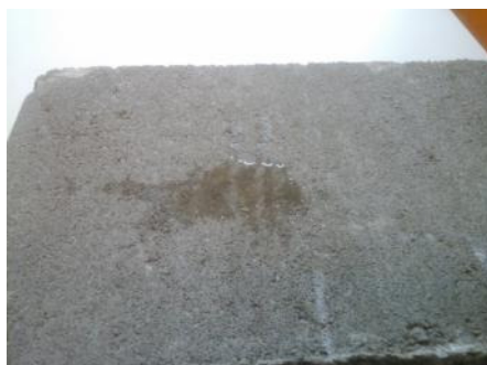
Figura 6 – Bloco de concreto durante teste de absorção.
